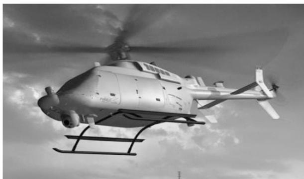
图 1 MQ-8C 火力侦察兵无人机
